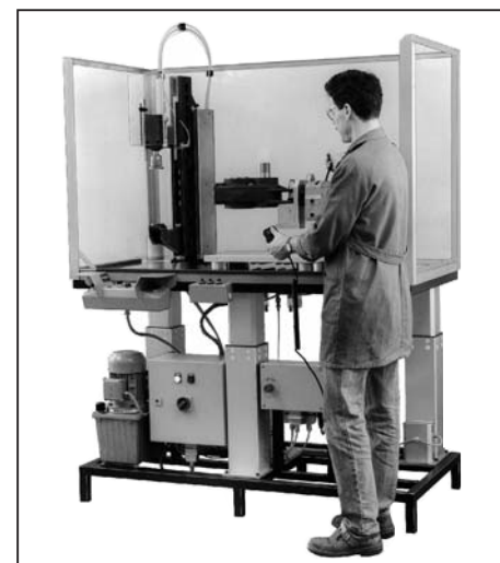
Posto di montaggio regolabile in altezza su 3 unità elettriche di sollevamento.
