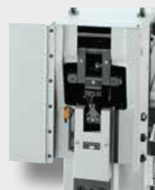
Ginocchiera regolabile per la regolazione fine del cursore della pressetta. Campo di regolazione: 16 mm
