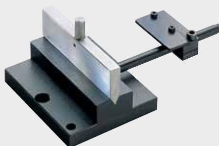
Attrezzo con prisma per piegature 90° oppure 60° con arresto longitudinale regolabile fino a 130 mm e 120 mm di larghezza.
