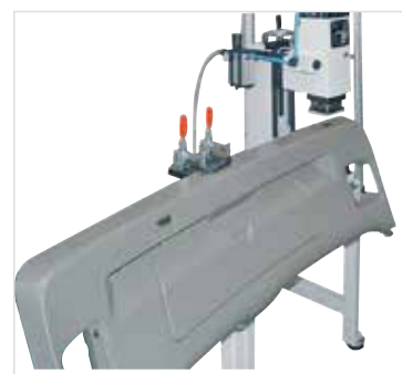
Attrezzatura per punzonatura rivestimento porte
