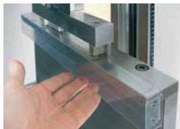
Attrezzatura di punzonatura per riparo in plastica
