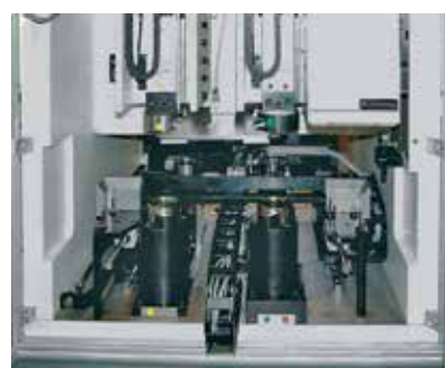
Attrezzatura di piantaggio
