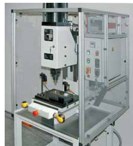
Attrezzatura di piantaggio
